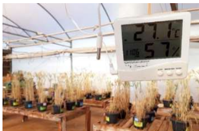
Figura 3 Termohigrômetro instalado no interior da casa de vegetação a 1,5 m de altura.
