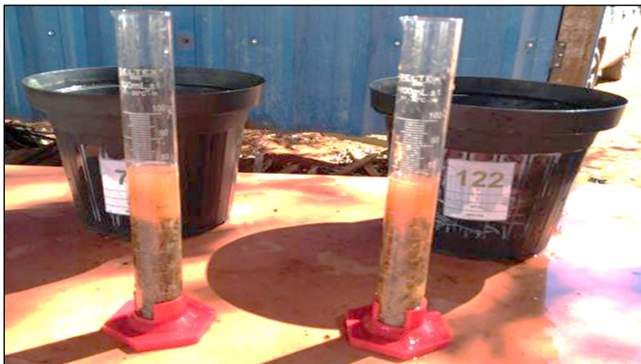
Figura 9. Determinação do volume de raiz com proveta graduada de 100 mL.
