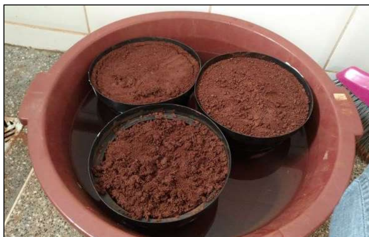
Figura 5. Solo saturando em recipiente com água para determinação da capacidade de vaso dos recipientes que compõem as parcelas.
