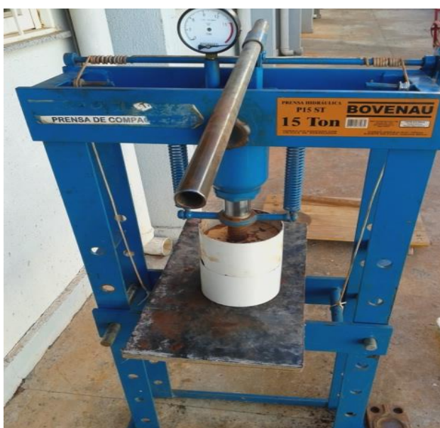
Figura 2. Compactação dos anéis centrais utilizando a prensa hidráulica P15 ST 15 Ton.
