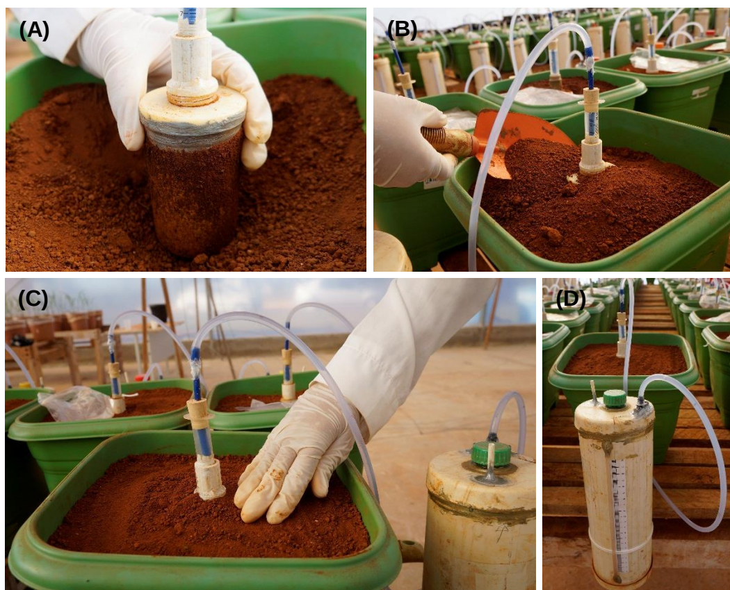
FIGURA 8. Alocação da vela de filtro na camada superficial e central do vaso (A); Preenchimento do vaso com solo adubado para cobrir a vela (B e C); Vela conectada ao reservatório de água através de um microtubo flexível (D).
